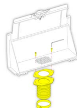
Montage des Entlüftungsadapters zur Absaugung
