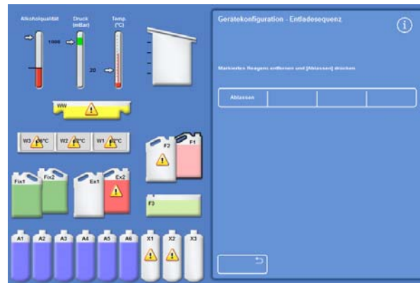
Ablassen von Spülreagenzien, F1 hervorgehoben
