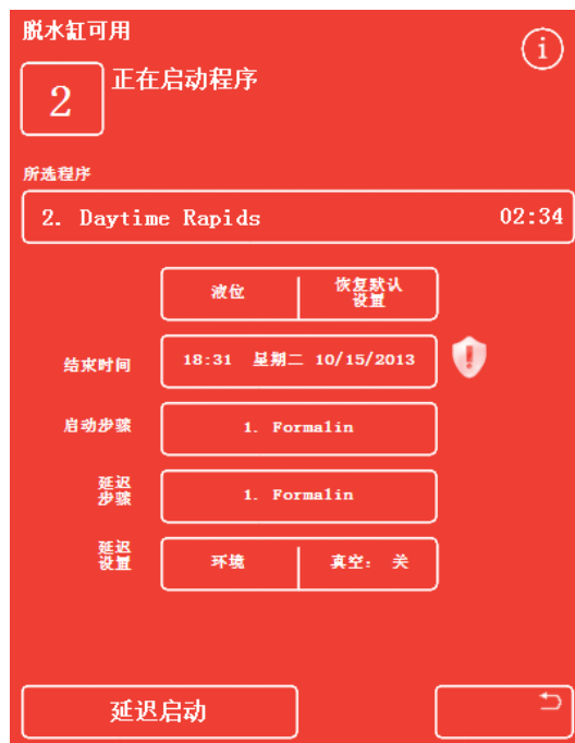
结束时间已更改 - 恢复默认设置按钮被启用
