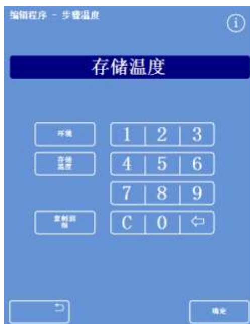
“编辑脱水程序 - 步骤温度”界面 (酒精和二甲苯)
