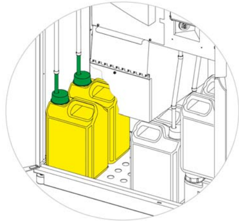
Garrafas de fixador em posição na Área de Armazenamento de Reagentes
