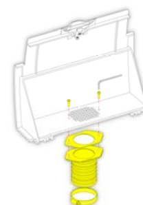
Montage van de extractieadapter voor ventilatie neerwaartse tocht
