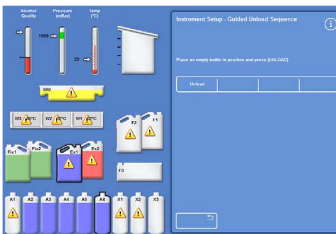
A6 dehydrantflasken og Utv1-plasseringen er markert
