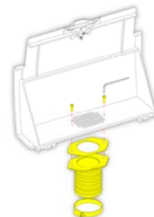
ダウンドラフト排気ベントアダプターの取り付け
