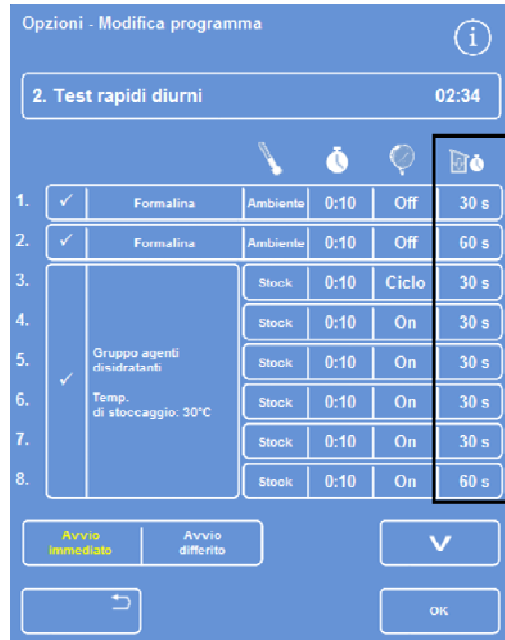
Schermata modifica programma (impostazioni del tempo della fase di drenaggio, in evidenza)
