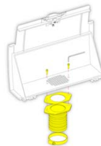
Montaggio dell'adattatore dello sfiato di estrazione downdraft
