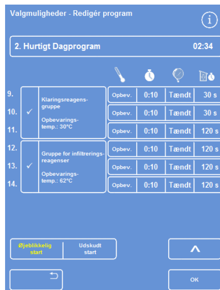
Oplysninger om trin med klaringsreagenser og infiltreringsmedie
