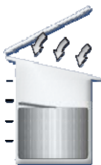
Kammeret er åbent, nedstrømsventilatoren er tændt
