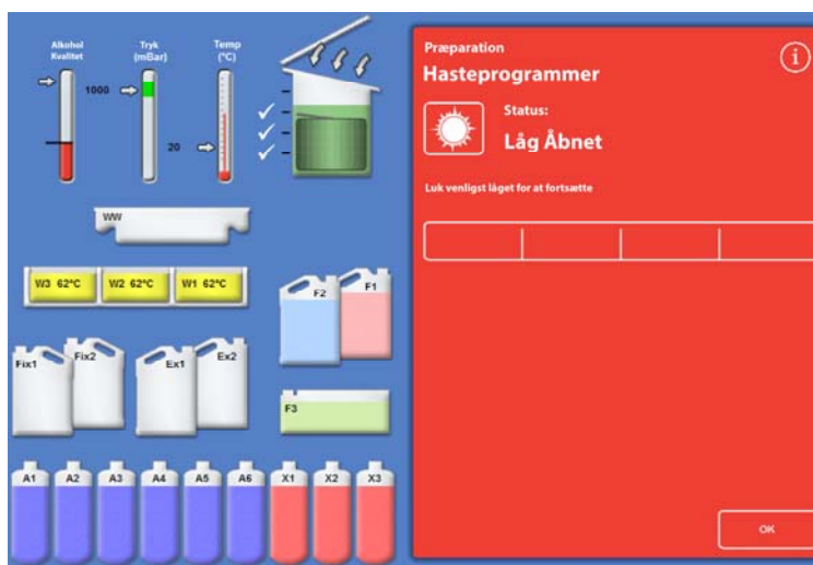
Når låget er frigivet og åbnet, vises skærbilledet Præparation
