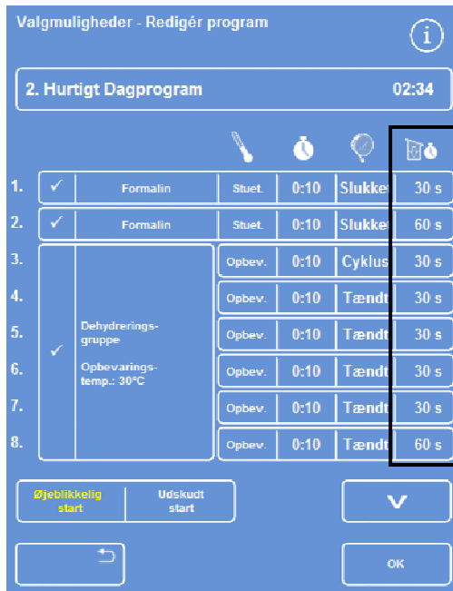
Skærbilledet "Redigér program" (trinnets afdrypningsindstilling er fremhævet)
