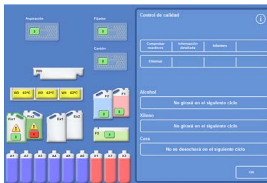
Renovación de Fix1 - Pantalla (Control de calidad)
