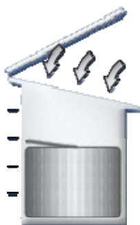
Cámara abierta, ventilador de tiro descendente encendido
