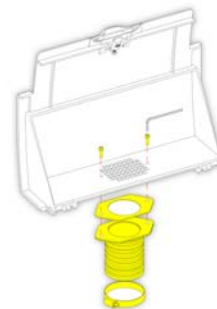
Colocación del adaptador de ventilación para extracción de tiro descendente
